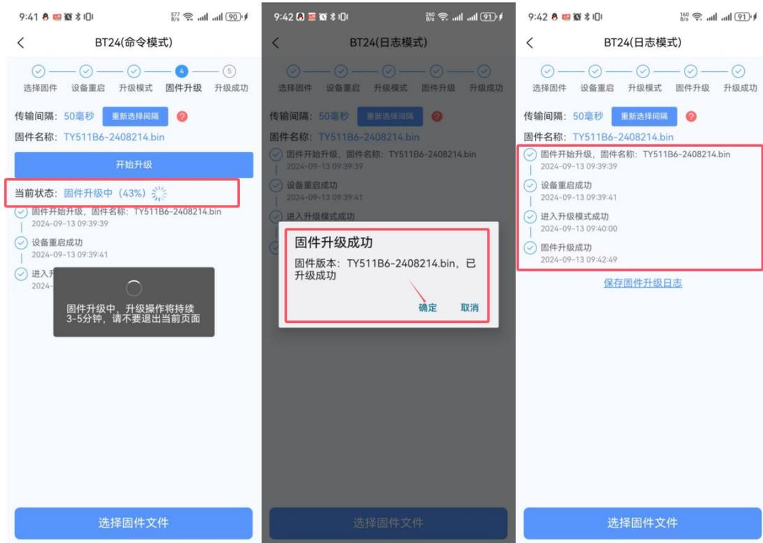
程序升级成功之后就可以对 RTU 设备进行所需要的参数配置
