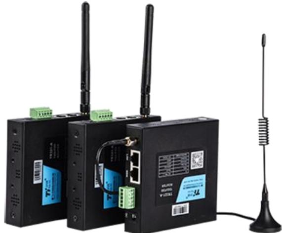
TR321系列工业路由器是一款小体积工业级物联网无线路由器（又名物联网工业网关），设计完全满足工业级标准和工业用户的需求，采用高性能的工业级32位通信处理器，软件多级检测和硬件多重保护机制来提高设备稳定性。支持中国电信、联通、移动4G网络并往下兼容3G、EDGE、CDMA 1X及GPRS网络，同时支持多种VPN协议（OpenVPN、IPSEC、PPTP、L2TP等）来保证数据传输的安全性。支持RS232（或RS485）、以太网接口和Wifi功能（可选）。
