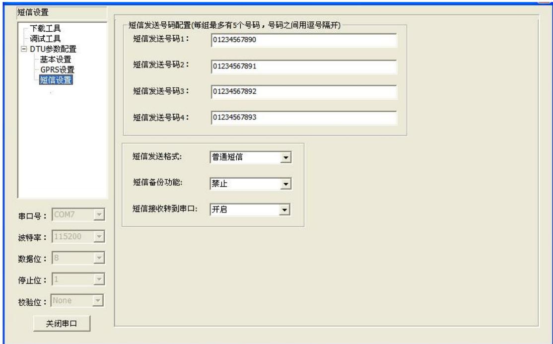
**短信发送号码：**每组可以设置 5 个手机号码，各个手机号码用逗号隔开的长度不超过 15 个数字。
